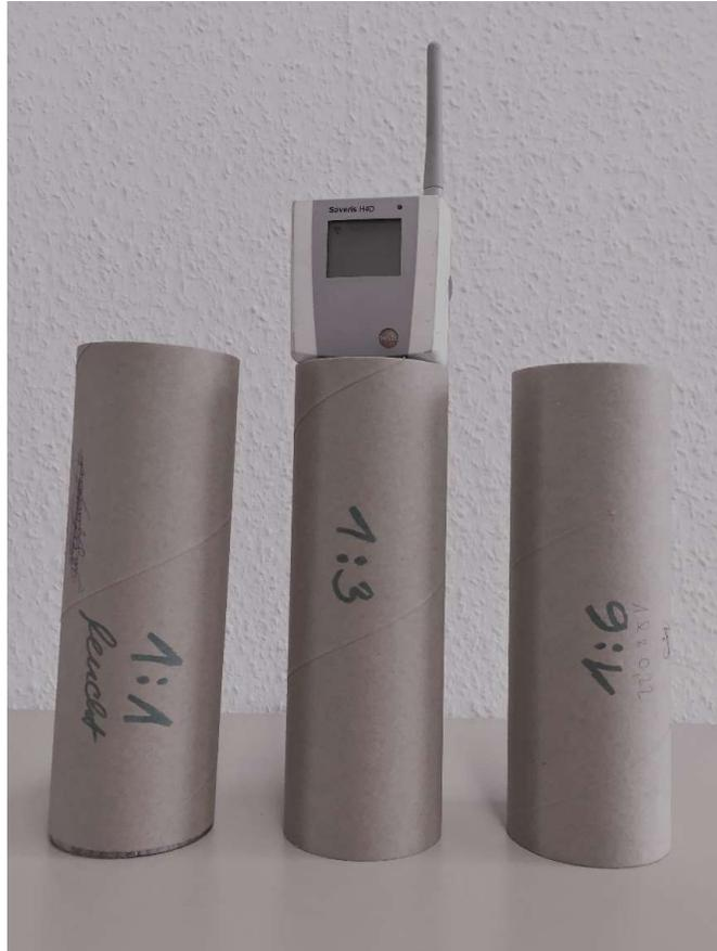
Messung der Feuchtigkeit in den Mischungen mit einem Fühler von Testo mit der Bezeichnung „Saveris H2D“.
